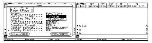
Dies kann auch über [VAR-LINK] überprüft werden. Nur im Folder versuch gibt es momentan eine Variable a. Speichern wir nun den Wert 20 unter der **Systemvariablen** xmax (Windowvariable) im Folder main ab und kontrollieren wir den Vorgang durch erneutes Aufrufen von xmax.
