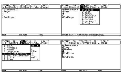
Ebenfalls unter [3] 1:Dialog findet man den **Befehl** Text mit dem Text in die Box geschrieben werden kann. Wir schreiben gleich den entsprechenden Text, kehren mit [2nd][ESC] in den Homebereich zurück und testen unser Programm. Text wird in der Box nicht umgebrochen. Man muß eigenständig gegebenenfalls weitere Zeilen mit dem Befehl Text gestalten.
