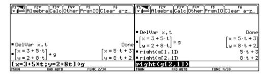
Wertet man die rechten Gleichungsseiten mit dem **With-Operator** ([1] = [2nd] (K)=) für t = 0 aus, so erhält man die Koordinaten des Punktes P(px, py) auf der Geraden g.
