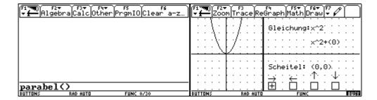
Mit Hilfe des Cursorpads • bzw. • kann der kreuzförmige Cursor zwischen den Schaltflächen bewegt werden. Mit der ENTER-Taste wird der Parabelscheitel in der angezeigten Pfeilrichtung um eine Einheit verschoben. Gleichzeitig werden die neue Gleichung und die Koordinaten des neue Scheitels angezeigt. Mit 2nd ESC wird das Programm verlassen.
