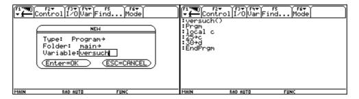
Wir kehren mit 2nd ESC in den Homebereich zurück. Dann wird das Programm versuch() gestartet (- nicht auf die Klammern vergessen). Danach kontrollieren wir die Belegung von c und d. Die Variable c ist unbelegt, sie wurde nur innerhalb des Programms, also lokal verwendet. Die Variable d ist belegt. Ihre Belegung bleibt auch nach Beendigung des Programms also **global** erhalten.
