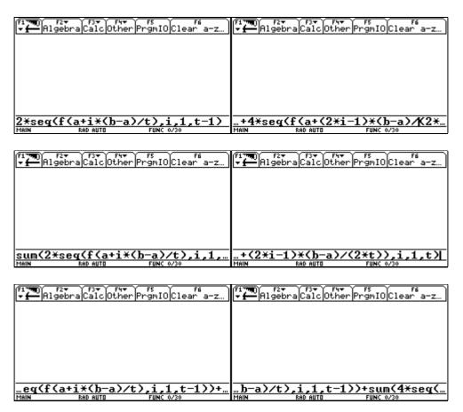
Der Funktionswert an den Stellen *a* und *b* ist dazuzuzählen und die entstandene Summe ist dann mit einem Sechstel der Länge eines Teilintervalles zu multiplizieren.
