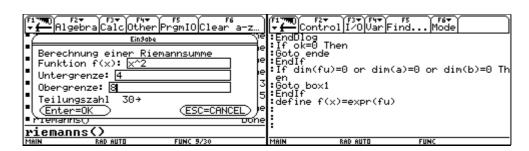
Auch die für untere und obere Grenze in a und b abgespeicherten Strings werden mit expr in Zahlenwerte verwandelt. Aus dem Wert von t wird die Teilungszahl 10t errechnet. Um die Berechnung der Riemannsumme besser verstehen zu können, definieren wir im Homebereich die identische Funktion als f(x).
