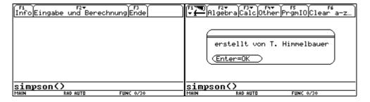
Nach ENTER wird das Programm beendet, ohne zur Menüleiste zurückzukehren. Daher kehren wir in das Programm zurück und setzen vor dem Befehl Toolbar das Label bar.
