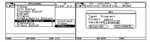
Anfang und Ende des Programms werden automatisch eingeblendet. Wir wenden uns zunächst dem Erstellen der Dialogbox für die Eingabe zu. Unter [53] finden wir bei Dialog das **Befehlspaar** Dialog - EndDlog. Damit sind Anfang und Ende der Befehlskette einer Dialogbox festgelegt.
