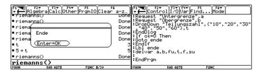
Jetzt wollen wir noch verhindern, dass die Box mit ENTER verlassen wird, wenn auf eine Eingabe vergessen wurde. Dazu untersuchen wir die Länge der eingegebenen Strings mit der Funktion dim. Ist die Länge Null, dann fehlt die entsprechende Eingabe. Wir setzen für diesen Fall einen Sprungbefehl zu einem Label box 1, das sich direkt vor dem Beginn der Dialogbox befindet.
