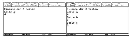
Das Pausezeichen rechts unten am Bildschirm deutet einen Programmstop an, der mit ENTER beendet wird. Der Bildschirm wird gelöscht und über F5 kehrt man in den Homebereich zurück.
