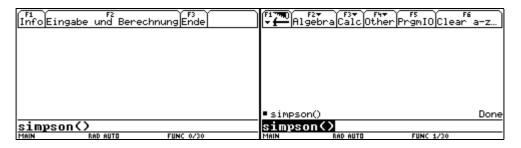
Mit dem Befehl **Item** können Unterpunkte für die Funktionstasten geschaffen werden. Für F2 legen wir die beiden Unterpunkte Eingabe und Berechnung an. Wenn Unterpunkte vorhanden sind, so sind für diese und nicht für die Hauptüberschrift Label anzulegen. Außerdem setzen wir hinter das Label m1, der für den Menüpunkt F1 Info steht, einen kurzen Informationstext. Die veränderte Menüleiste wird sofort getestet.
