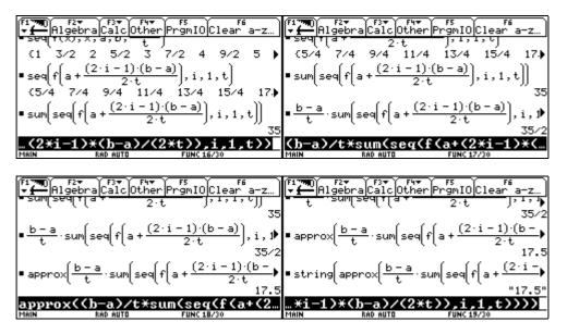
Nach dem wir unser Programm wieder geöffnet haben fügen wir den Befehl zur Berechnung der Riemannsummen mit • V entsprechend ein. Die Riemannsumme wird als **String** der Variablen su zugewiesen, die in der folgenden Dialogbox über den **Request-Befehl** ausgegeben wird.
