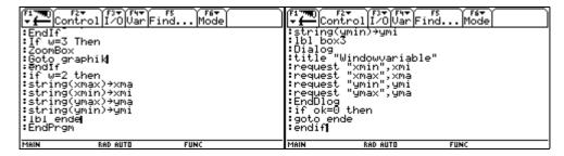
Nach dem Verlassen der Dialogbox müssen die Strings wieder in Werte umgewandelt werden, wodurch auch die [WINDOW]-Variablen mit neuen Werten belegt werden. Zuletzt wird zum Label graphik zurückgesprungen. Am Ende des Programms müssen wir noch die Modi zurückstellen und die Variablen löschen. Das Löschen muss - wie immer - auch noch zu Beginn des Programms vervollständigt werden.
