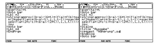
Am Programmende und -anfang löschen wir alle Variablen. Außerdem initialisieren wir die Variablen der Eingabedialogbox mit leeren Strings.
