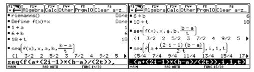
Mit **sum** wird die Liste der Funktionswerte addiert und muß nur noch mit der konstanten Teilintervalllänge (a-b)/t multipliziert werden, um die Riemannsumme zu ergeben. Mit approx lassen wir uns einen Näherungswert errechnen und verwandeln diesen mit **string** in eine Textkonstante. Diesen – nun schon recht langen - Befehl kopieren wir mit  $\bullet$   $\bigcirc$  in die Zwischenablage.
