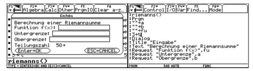
Nun soll festgelegt werden, was geschehen soll, wenn ein Benützer in der Box ESC wählt. Ob in der Box ESC gedrückt wurde oder nicht, wird von der Systemvariablen ok wahrgenommen. Besitzt sie den Wert 0, so wurde ESC gedrückt. Wir springen in diesem Fall mit einem Sprungbefehl Goto zu einer Markierung Lbl (genannt Label) am Ende des Programms. Diesem Label geben wir die Bezeichnung ende. Um diese Veränderung testen zu könne, geben wird nach dem Label ende noch einen Textbefehl ein.
