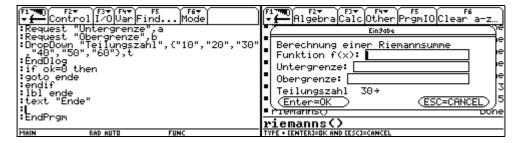
Die Box mit dem Text "Ende" bestätigt die Richtigkeit unserer Programmierung. Nach Lbl ende führen wir das Löschen der Variablen durch.
