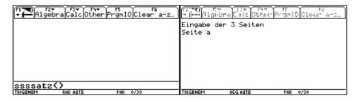
Danach sind auch die Seiten b und c einzugeben. Nach der Bestätigung von c mit  $\overline{\text{ENTER}}$ , wird der PrgIO gelöscht und die Ergebnisse der Winkelberechnung angegeben.
