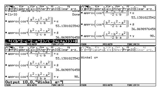
Mit dem Befehl Output kann sowohl ein Text als auch der Wert einer Variablen ausgegeben werden. Über die Angabe von Zeile,Spalte kann die Ausgabe am Bildschirm genau gesteuert werden. Der Bildschirm hat 102 Zeilen und 239 Spalten. Die Zeilen werden von oben und die Spalten von links gezählt. Ein Text muß unter immer unter " " gesetzt werden.
