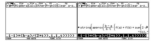
.... mit •V setzen wir die Näherungsformel an der entsprechende Stelle in unser Programm ein und weisen sie der Variablen su zu. Dann geben wir ihren Wert über eine Dialogbox mit Hilfe von Request aus.
