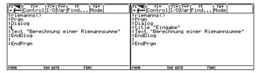
Auch diese Veränderung betrachten wir sofort mit einem Programmstart. Zurückgekehrt in den Editor verwenden wir den Befehl Request zur Eingabe von Werten durch den Benutzer. Dieser Befehl wird gefolgt von Text unter "" und getrennt durch einen Beistrich von einem Variablennamen, unter dem die Eingabe des Benützers als **String** gespeichert wird.
