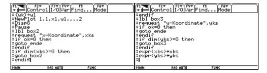
Anschließende wird die Richtigkeit der Eingaben überprüft. Der MODE muss zurückgestellt und der angelegte Plot deaktiviert werden. Die benutzten Variablen gehören gelöscht. Auch am Programmanfang müssen die Variablen beim Löschbefehl ergänzt werden.
