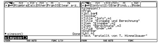
Dann setzen wir am Ende, der durch die Label m1, m2 und m3 bestimmten Abschnitte jeweils einen **Sprungbefehl** zurück zum Lbl bar. Damit wird immer wieder die Menüleiste aufgerufen. Nur beim Lbl m4, das ja bei der Auswahl von F3 Ende angesprungen wird, setzen wir keinen Sprungbefehl.
