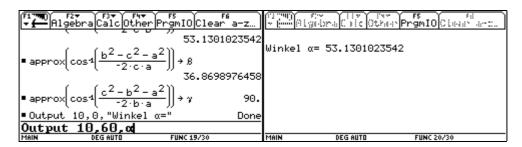
Eine Variable, deren Wert ausgegeben werden soll, muß ohne "angeführt werden. Alternativ könnte man zur Befehlsausgabe auch den Befehl **Disp** verwenden. In unserem Beispiel mit dem Befehl: Disp "Winkel  $\alpha$  ="&string( $\alpha$ )
