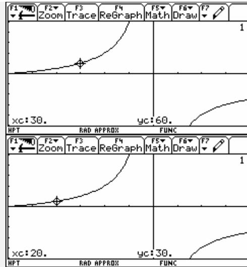
Für  $f < 60$  ( d.h.  $g > f$  ) ist die Funktion  $b(f,60)$  streng monoton steigend; eine Linse mit größerer Brennweite erzeugt von einem Gegenstand in gleicher Gegenstandsweite ein größeres Bild, da gilt
