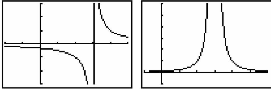
Die für  $f(x)$  angezeigte „Asymptote“ entsteht durch eine Verfälschung. In der Graphikansicht werden nämlich diskret berechnete Punkte des Graphen in Bildpunkten (Pixel) dargestellt, wobei die Bildpunkte miteinander linear verbunden werden. Dadurch entsteht bei Polstellen mit Vorzeichenwechsel der Eindruck einer senkrechten Asymptote. Polstellen ohne Vorzeichenwechsel zeigen diesen Effekt nicht.
