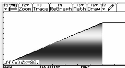
Die erforderliche Kraft zum Herausziehen des Körpers steigt von 0 auf 40N an; sobald der Körper nicht mehr eintaucht muss beim weiteren Heben gegen die Gewichtskraft (= 40 N) Arbeit verrichtet werden.
