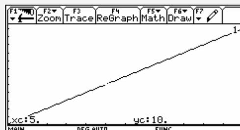
Das Fahrzeug hat also in den ersten 10s den gleichen Weg zurückgelegt als hätte es sich mit der halben Endgeschwindigkeit die vollen 10s gleichförmig bewegt; dieser Zusammenhang wird aus der Deutung der Fläche unterhalb des  $v - t$ -Grafen deutlich.
