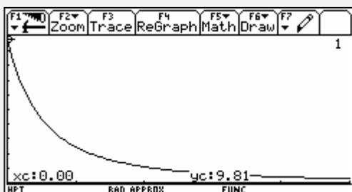
Aus der Definition der Arbeit gleich „Kraft mal Weg“ ergibt sich die Notwendigkeit der Flächenberechnung, die der Graph für die Gravitationskraft im 1. Quadranten mit der x-Achse einschließt.
