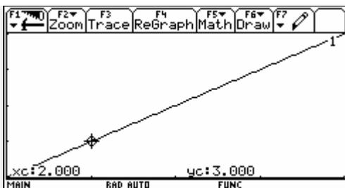
Es handelt sich um das  $v - t$  - Diagramm eines gleichmäßig beschleunigten Massenpunktes. Die Steigung der Geraden ist konstant und lässt sich aus der Grafik ermitteln. Physikalisch gibt die Steigung der Geraden die Beschleunigung des Massenpunktes an.
