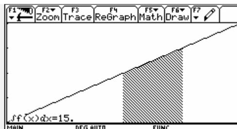
Allgemein ist bekannt, dass die Fläche unter der Kurve im  $v - t$  - Diagramm einer Bewegung zwischen den Zeitpunkten  $t_1$  und  $t_2$  den in der Zeit  $t_2 - t_1$  zurückgelegten Weg repräsentiert.
