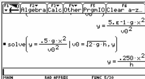
In diese Gleichung setzen wir die Koordinaten des Auftreffpunktes B ( $x_W / h_0 - h$ ) ein und lösen nach  $x_W$  auf:
