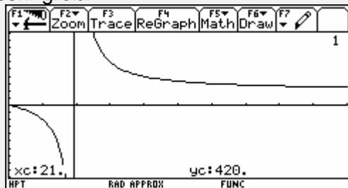
Wenn  $g = 2f$  (doppelte Brennweite) so erhalten wir für  $b = 2f$ ; das Bild ist gleich groß wie der Gegenstand und von der Linse gleich weit entfernt.
