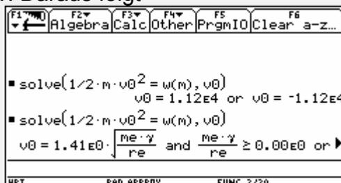
Die auch als Fluchtgeschwindigkeit bezeichnete Abschussgeschwindigkeit der Masse  $m$  beträgt  $11,2 \text{ km/s}$  und ist (unabhängig von der Masse) für alle Körper gleich.
