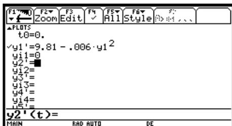
Diese in der Lösungskurve sichtbare Endgeschwindigkeit tritt dann ein, wenn der Luftwiderstand die Größe der Schwerkraft erreicht. Durch Gleichsetzen von  $F_g$  und  $F_w$  erhält man also
