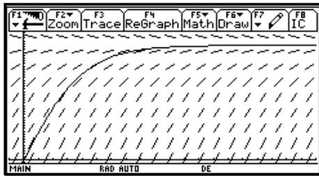
funktion bei Luftreibung: die anfangs linksgekrümmte Funktion geht in eine lineare über (wenn nämlich die Geschwindigkeit konstant wird).
