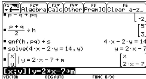
Es wird die Streckensymmetrale in Normalvektorform ermittelt und als s abgespeichert.
