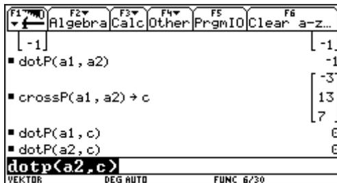
Zuerst bilden wir mit  $\text{dotP}(a_1, a_2)$  das skalare Produkt.
