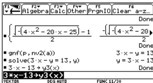
Die Gerade in Normalvektorform anlegen, nach  $y$  lösen und als  $y_3(x)$  speichern.
