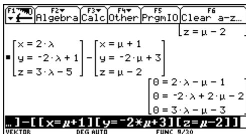
Die Geradengleichungen werden subtrahiert, dieses Gleichungssystem in Form einer Matrix bleibt über.
