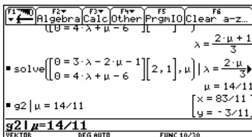
Die Koordinaten des Schnittpunktes werden berechnet und abgespeichert.
