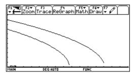
Nach 1,5 m Bremsweg erfolgt daher der Aufprall mit kaum reduzierter Geschwindigkeit (36 km/h). Aus diesem Diagramm kann man z.B. auch ablesen, daß selbst nach 6 m Bremsweg- wo also nur mehr 2 m fehlen- noch die Hälfte der Ausgangsgeschwindigkeit vorhanden ist.
