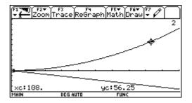
Damit zeigt das Diagramm oberhalb der v-Achse die Bremsstrecke als Funktion der Geschwindigkeit v für die Bremsverzögerung a = 1m/s² und unterhalb der v-Achse ist der Reaktionsweg in Abhängigkeit von der Geschwindigkeit für eine Reaktionszeit von einer Sekunde aufgetragen. Die Addition der beiden Wegstrecken liefert die Anhaltestrecke bei der entsprechenden Geschwindigkeit.
