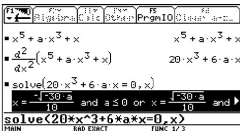
Die 2. Ableitung wird gleich 0 gesetzt. Die Gleichung hat für  $a > 0$  keine reelle Lösung ausgenommen  $x = 0$ .
