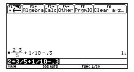
Die Eingabezeile ist invers dargestellt; sie wird daher durch einen Tastendruck gelöscht bzw. überschrieben. Will man aber ihren Inhalt erhalten, muss man zunächst  $\bigcirc$  oder  $\bigcirc$  drücken und damit den Cursor an das Zeilenende oder den Zeilenanfang setzen, wobei auch gleichzeitig die Markierung aufgehoben wird. Jetzt kann man sich mit Hilfe der Cursortaste(n)  $\bigcirc$  und  $\bigcirc$  an jede beliebige Stelle der Eingabezeile bewegen und Korrekturen vornehmen.
