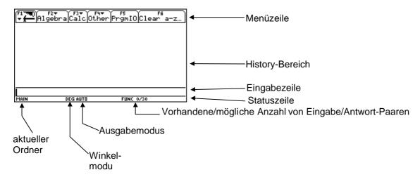
In der Eingabezeile wird nun die gewünschte Rechnung eingetippt und mit der **ENTER** -Taste abgeschlossen. Danach erscheint die Eingabe im sogenannten Pretty-Print auf der linken Seite des History-Bereiches. Rechts wird das Ergebnis angezeigt.
