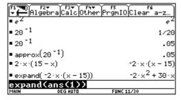
Die im obigen Fenster verwendeten Funktionen approx bzw. expand kann man über die Tastatur eintippen oder (einfacher) aus der Menüzeile aufrufen. Geöffnet wird jedes Menü mit der darüberstehenden Funktionstaste. **F1** etwa öffnet das Werkzeugmenü:
