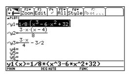
Zur besseren Unterscheidung der Graphen ist es sinnvoll, die Anzeigestile der drei Funtion verschieden zu wählen. Diese Einstellungen werden im Menü "F6 Style" vorgenommen. Der Cursor wird auf die zu verändernde Funktion gesetzt, F6 gedrückt und der gewünschte Stil - hier thick für y1, dot für y3 - ausgewählt. Durch [GRAPH] werden die drei Funktionen geplottet.
